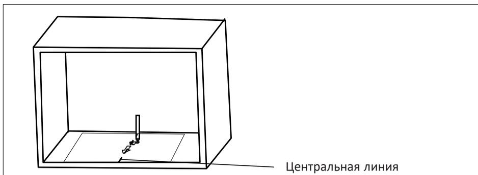
3. Снимите шаблон для установки и закрепите скобу винтом А.
