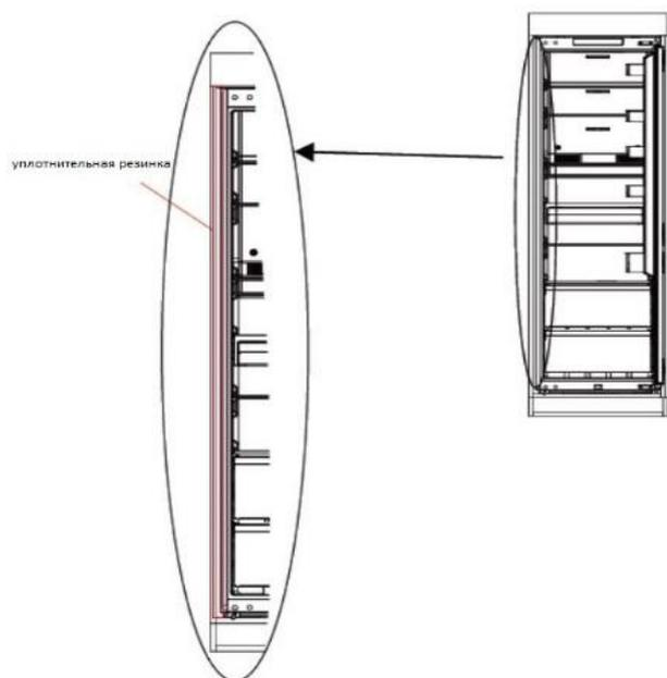
2. Аккуратно установите холодильник в нишу. Отрегулируйте его так, чтобы верхний козырек был плотно прижат к верхнему краю ниши, а ограничитель снизу вплотную прилегал к нижней стенке шкафа.
