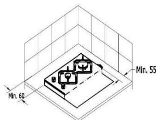
Варочная поверхность имеет специальный уплотнитель, который предотвращает протекание жидкостей через отверстия в шкаф. Чтобы установить этот уплотнитель, наклейте его, как описано на рисунке выше. Переверните варочную поверхность, снимите защитную ленту с резиновой прокладки и наклейте ее на плиту, оба конца прокладки должны быть точно совмещены. Установите монтажные пластины с помощью болтов, как показано на рисунках 4 и 5. Затем вставьте варочную поверхность в отверстие в столешнице.
